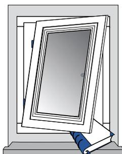
DO NOT ALLOW THE SASH TO HIT OR PRESS UP AGAINST THE WINDOW REVEAL.
